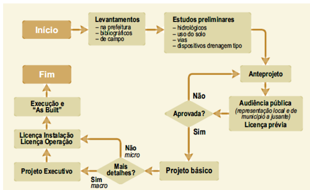
Figura 6 - Fluxograma das fases de um projeto de drenagem urbana
