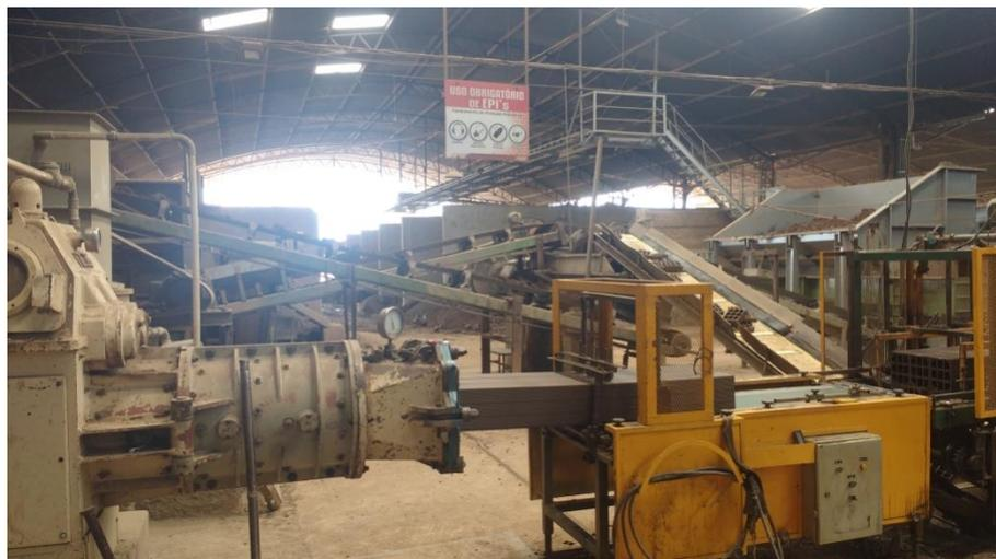
**Figura 37: Extrusão/ corte**
