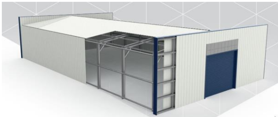
Figura 6. Galpão com duas águas.
