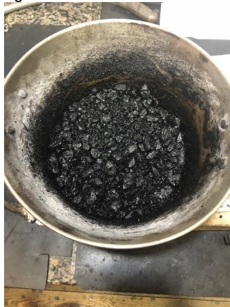
Figura 30 – Detalhe da mistura homogeneizada
