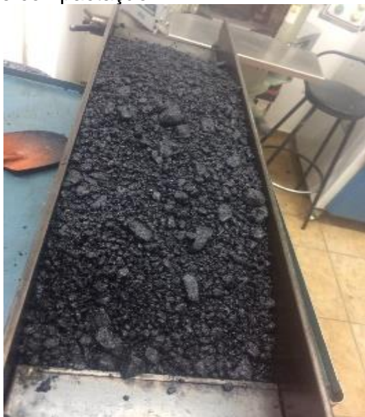
Figura 42 – Mistura asfáltica na forma de compactação
