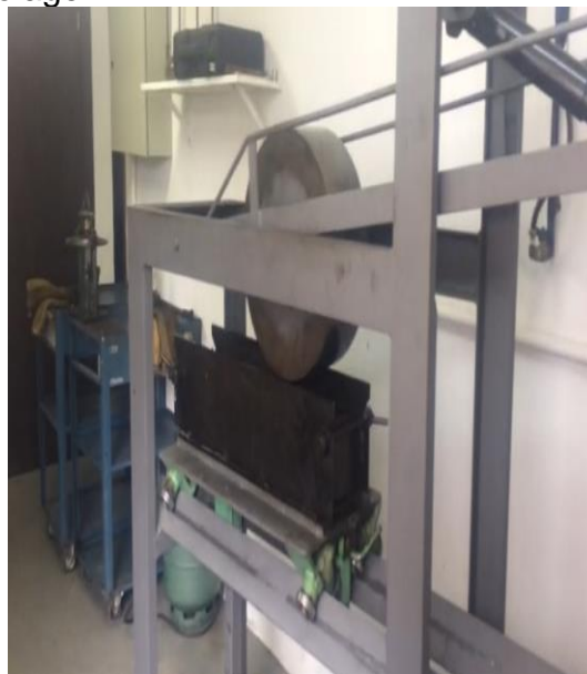
Figura 43 – Compactação através de rolagem
