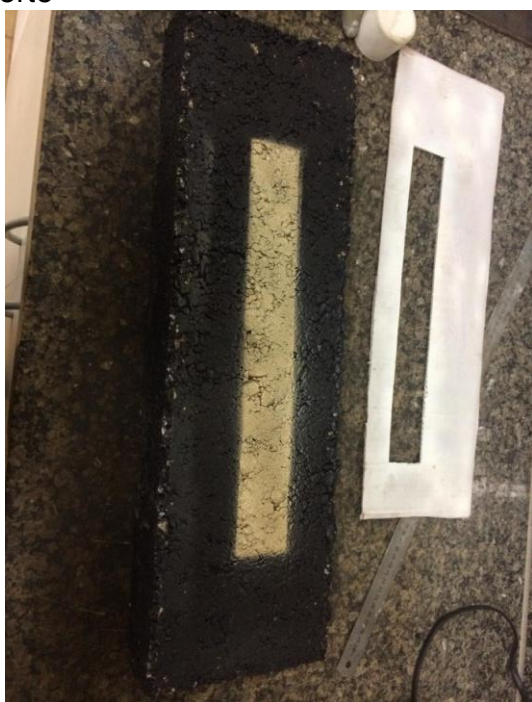
Figura 44 -Detalhe de demarcação para corte
