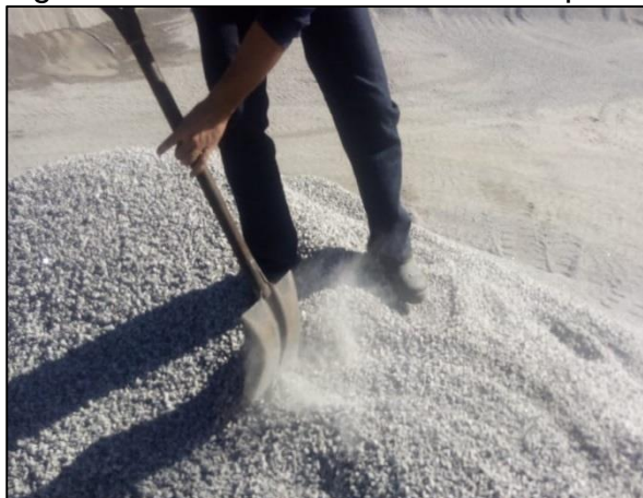
Figura 23 – Coleta com o auxílio da pá
