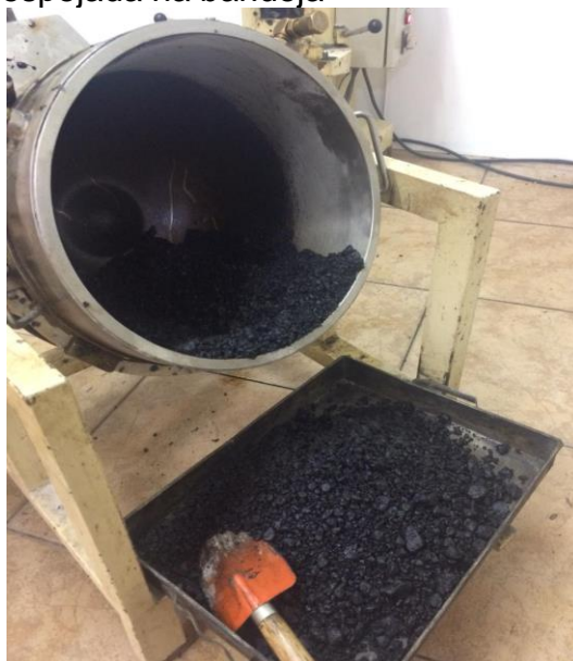
Figura 41 – Mistura asfáltica sendo despejada na bandeja
