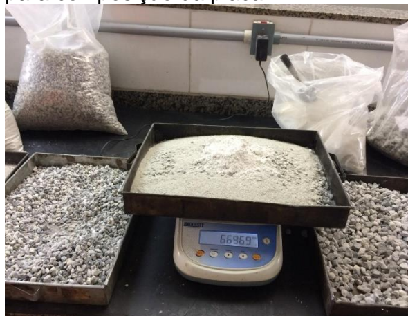
Figura 35 – Pesagem dos agregados para composição da placa
