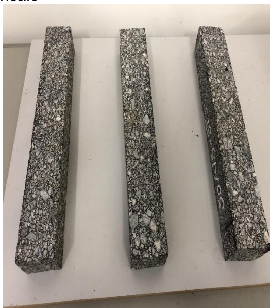
Figura 48 – Vigotas preparadas para ensaio
