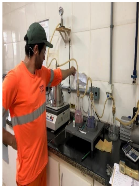
Figura 32 - Ensaio Rice Teste
