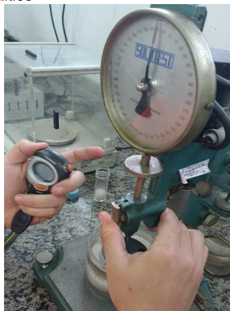
Figura 19 - Penetrômetro para determinação da penetração do ligante asfáltico
