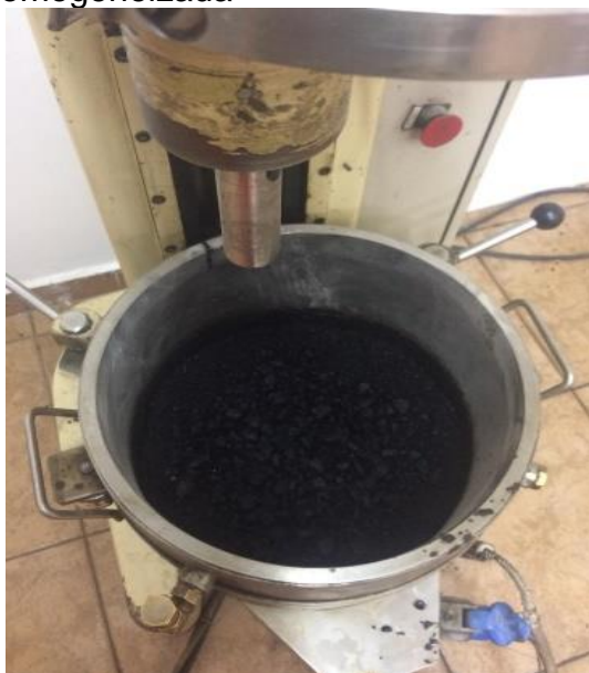
Figura 40 – Mistura asfáltica homogeneizada
