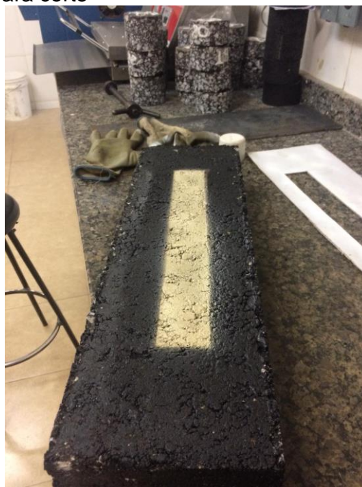
Figura 45 – Detalhe da demarcação para corte
