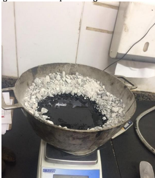
Figura 36 – Adição do ligante asfáltico
