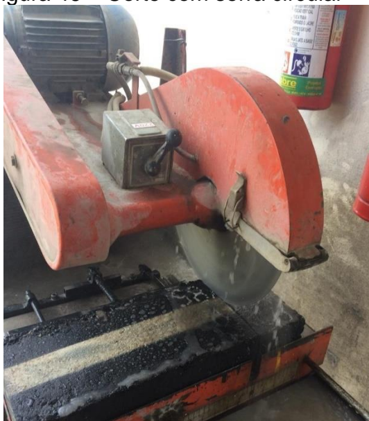
Figura 46 – Corte com serra circular
