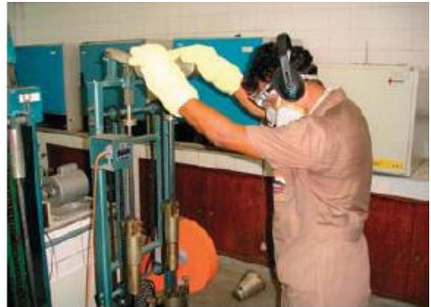
**Figura 22 (e): Extração do corpo de prova do molde**
