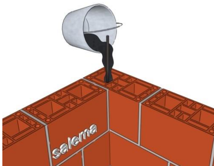
Figura 10, Graute no vão do bloco de cerâmica, Fonte: www.ceramicasalema.com.br (2018)
