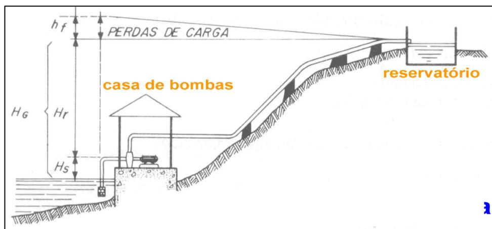
Figura 3- Modelo de estação elevatória.
