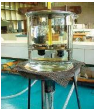
Figura 9: Representação do ensaio de ponto de amolecimento.
