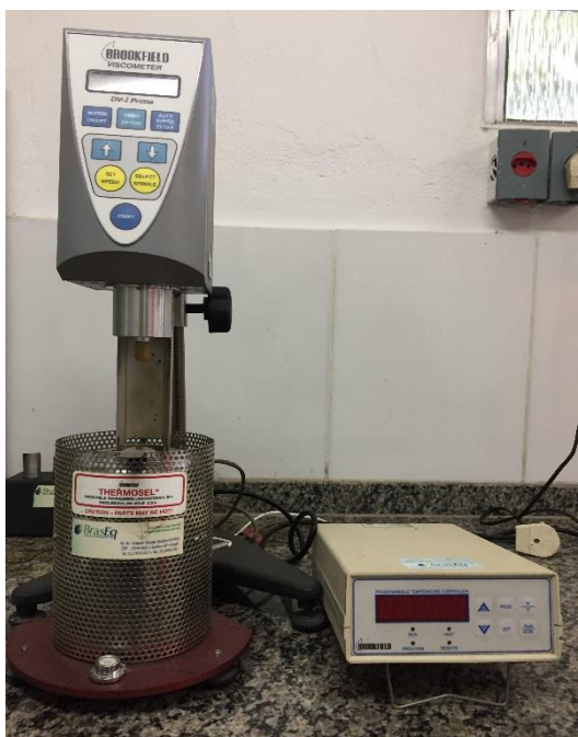
Figura 12: Representação do equipamento de ensaio de viscosidade Brookfield
