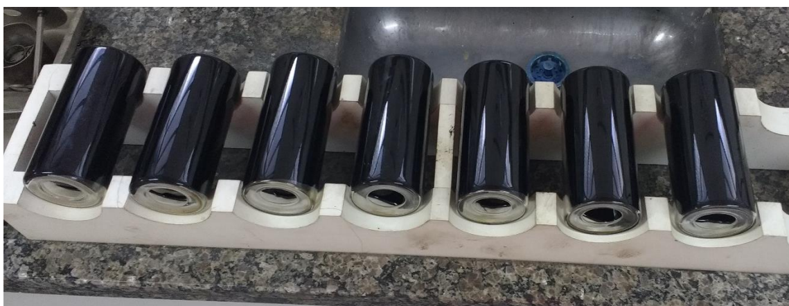
Figura 15: Representação dos recipientes cobertos após o ensaio RTFOT
