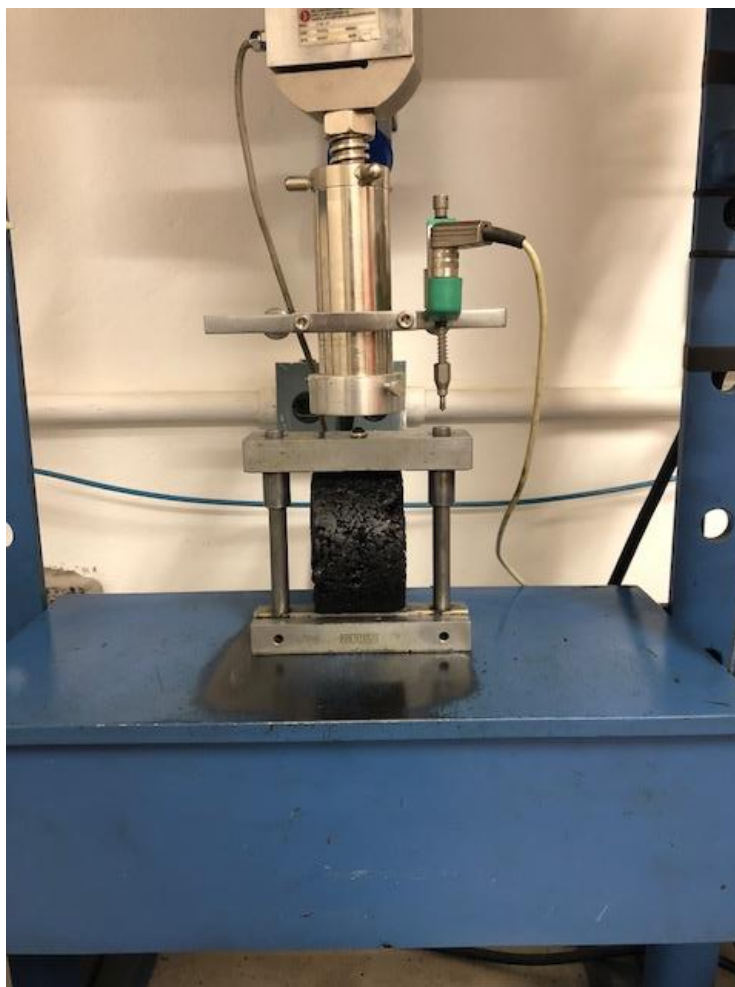
Figura 20: Esquema para rompimento por compressão diametral
