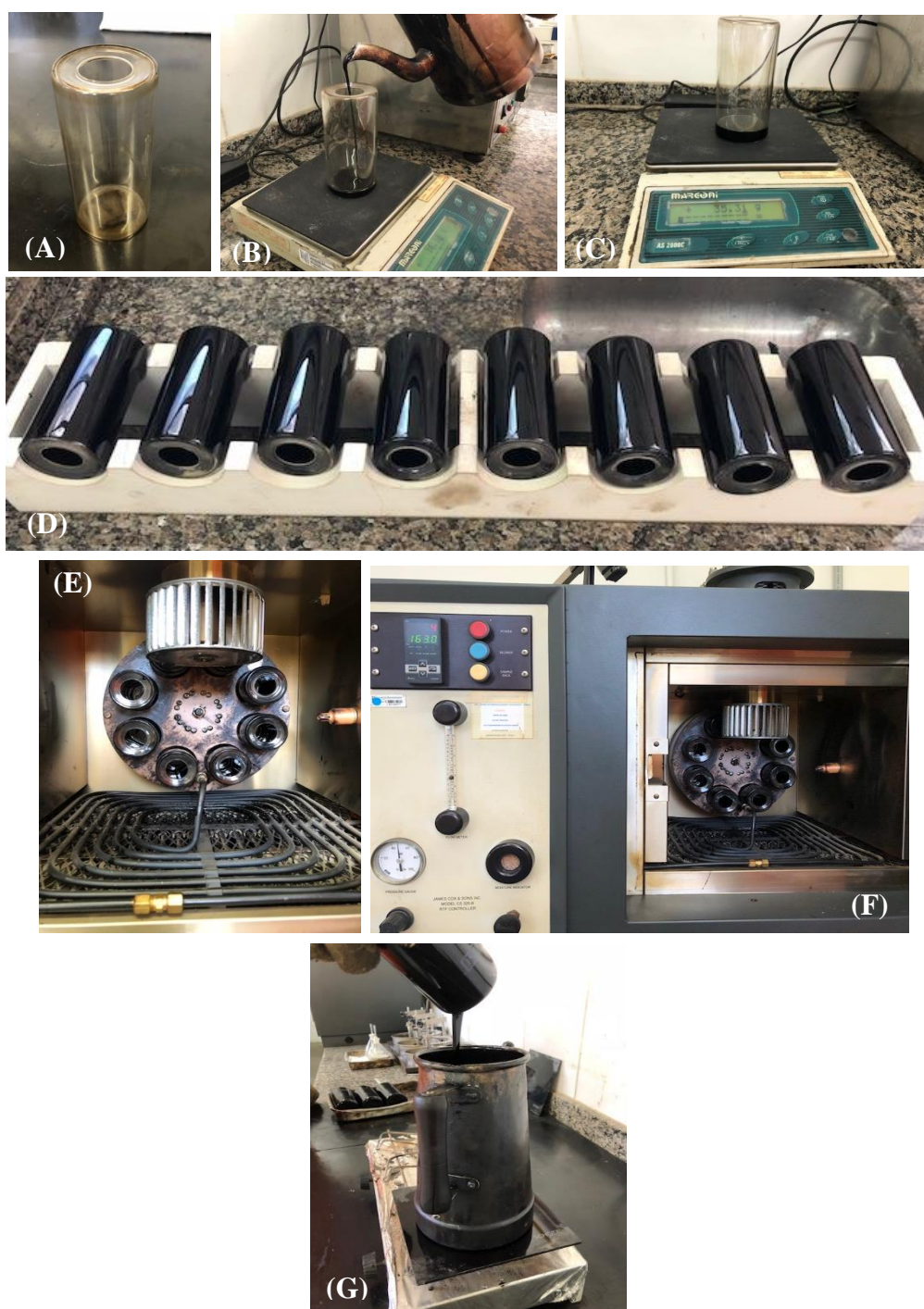
Figura 19: RTFOT - Esquema do ensaio.
