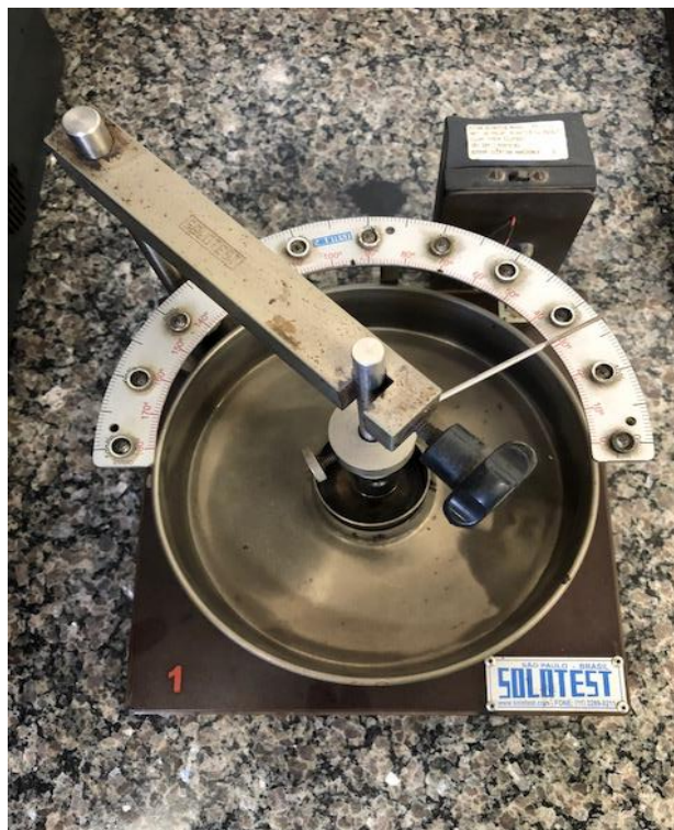
Figura 11: Representação do equipamento de ensaio de recuperação elástica por torção
