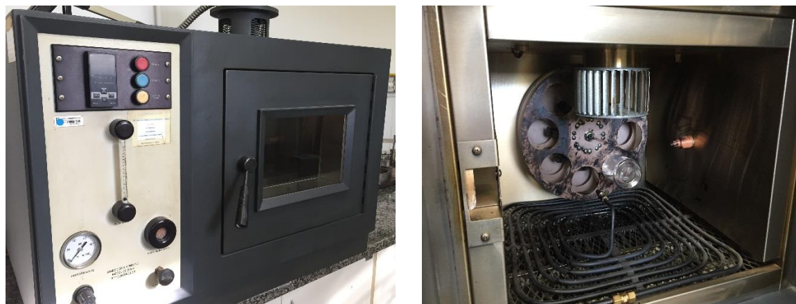
Figura 14: Representação do ensaio de Envelhecimento do CAP
