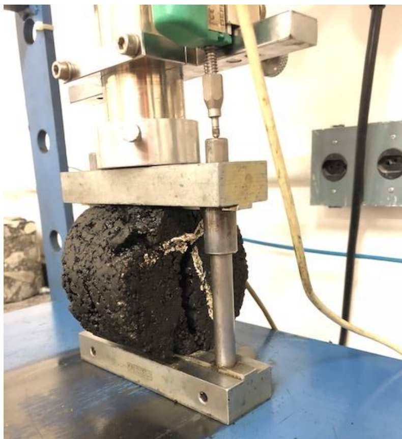
Figura 21: Rompimento do corpo de prova por compressão diametral
