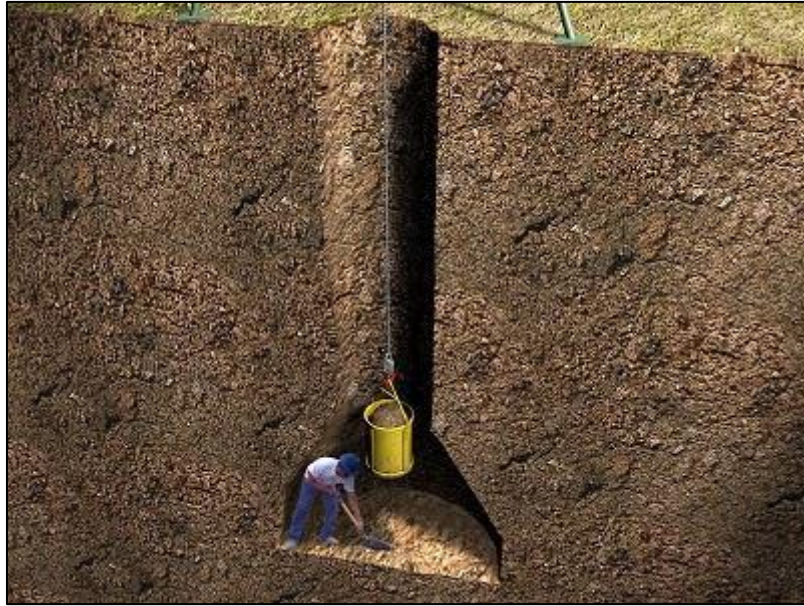
Figura 8 - Tubulão a Céu Aberto
