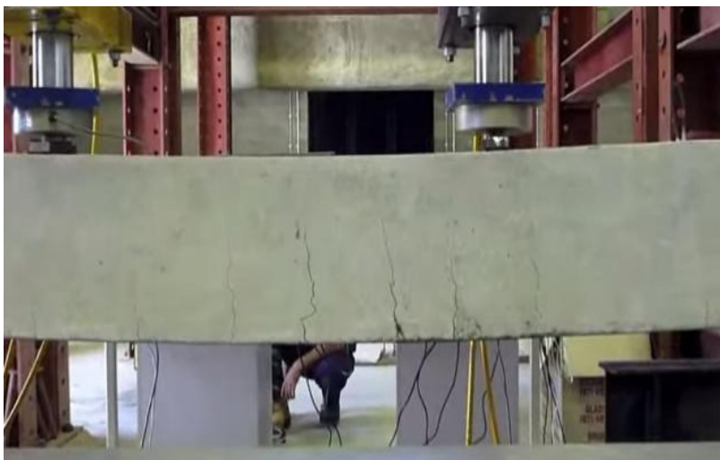
Figura 3- Esforço de tração causados pela flexão.
