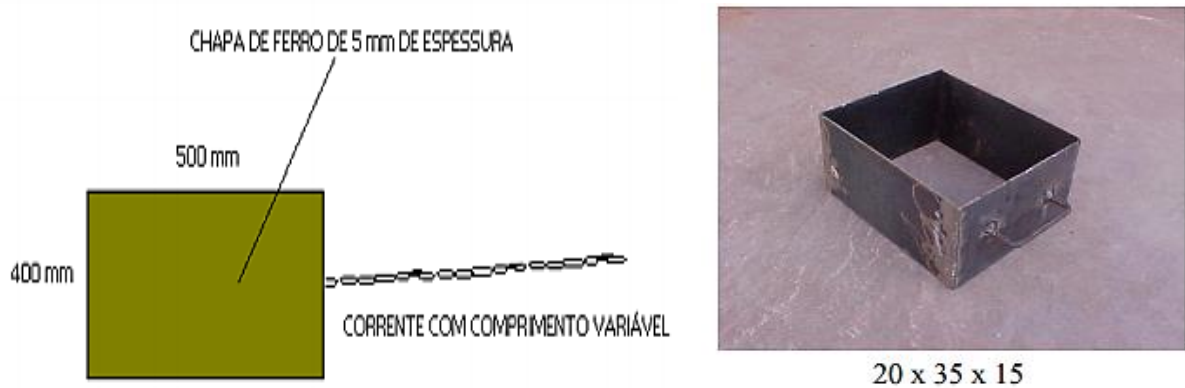
Figura 35 – a e 35 – b - Coleta de Amostras de Mistura Asfáltica na Pista (Atrás da Acabadora)
