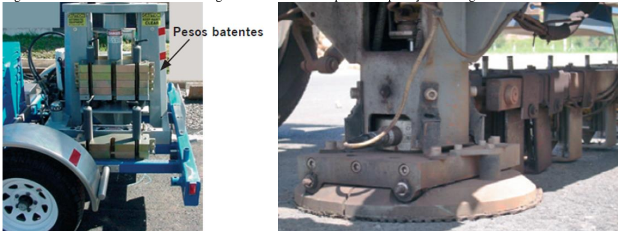
Figura 11 - Detalhe do sistema de carregamento e detalhe do prato de aplicação de carga e da barra de sensores
