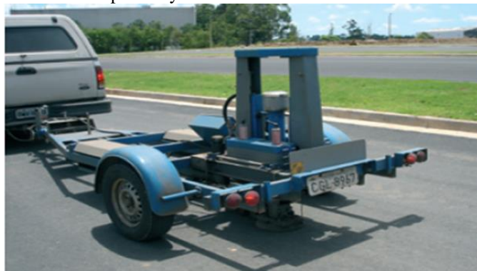
Figura 10 - Vista geral do FWD da empresa Dynatest
