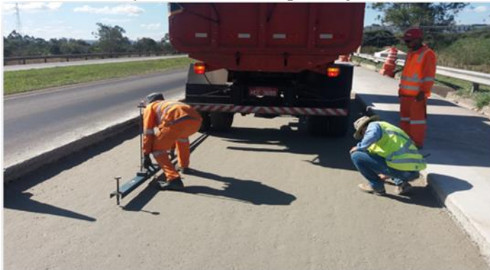
Figura 36 – Determinação das Deflexões pela viga Benkelman
