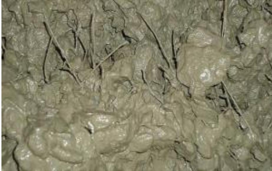
Figura 14 - Adição de fibra de aramida ao concreto para potencializar seu comportamento
