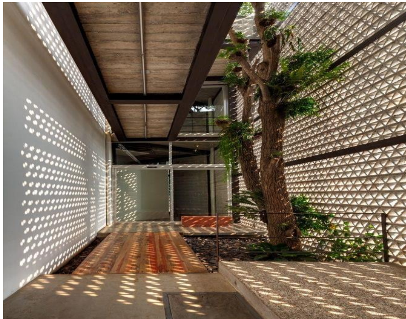
Figura 2: Iluminação natural utilizando Cobogó. Fonte: decorfacil.com.
