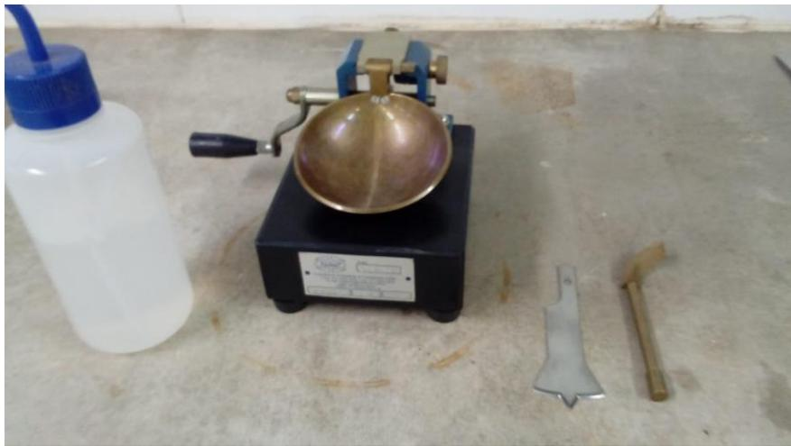
Figura 4 - Aparelho Casagrande - Ensaio de Limite de Liquidez
