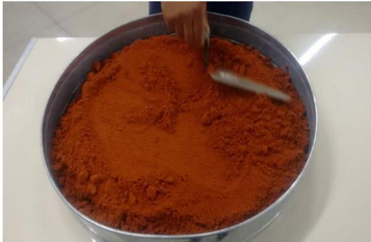
Figura 3 - Solo peneirado para a mistura
