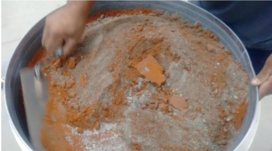
Figura 8 - Mistura dos materiais para a confecção dos tijolos de solo-cimento/RBC
