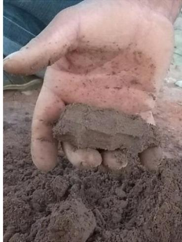
Figura 10 - Teste prático tático visual da consistência ideal da massa
