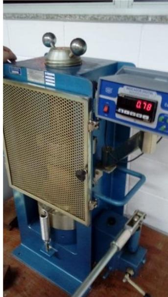
Figura 14 - Tijolo sendo comprimido
