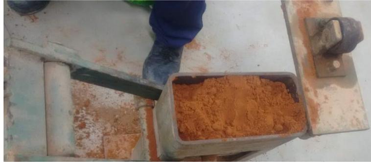
Figura 12 - Mistura no molde da prensa
