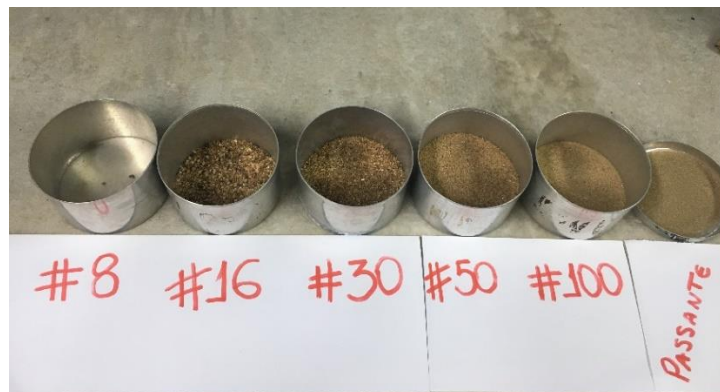
Figura 6 - Análise Granulométrica Agregado Natural
