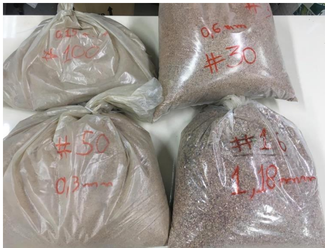
Figura 2 - Agregado natural (laboratório da Faex)
