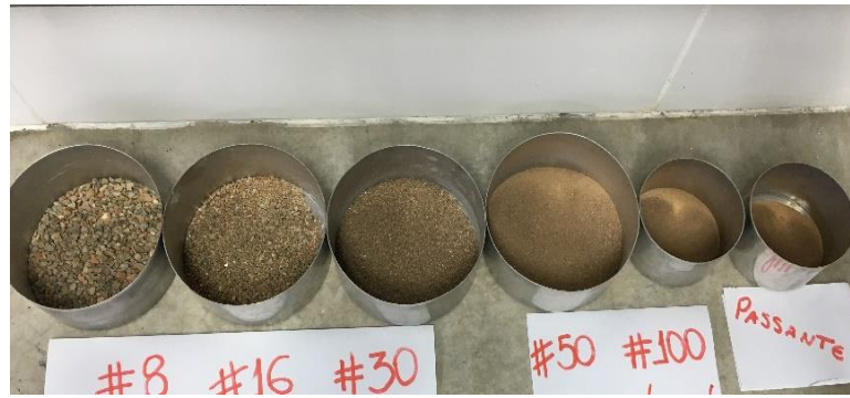
Figura 7 - Análise Granulométrica Agregado Reciclado de RCD e auto pista
