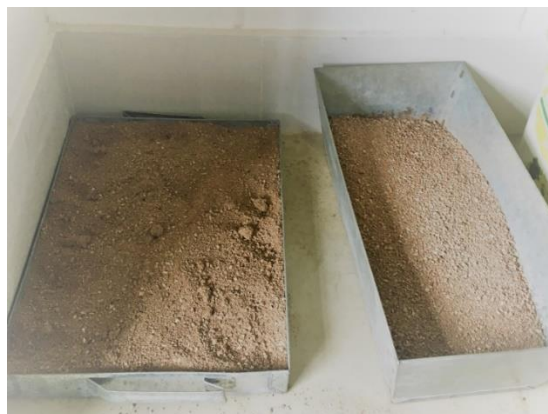
Figura 4 - Agregado Reciclado de RCD e asfalto (Usina RRCC)
